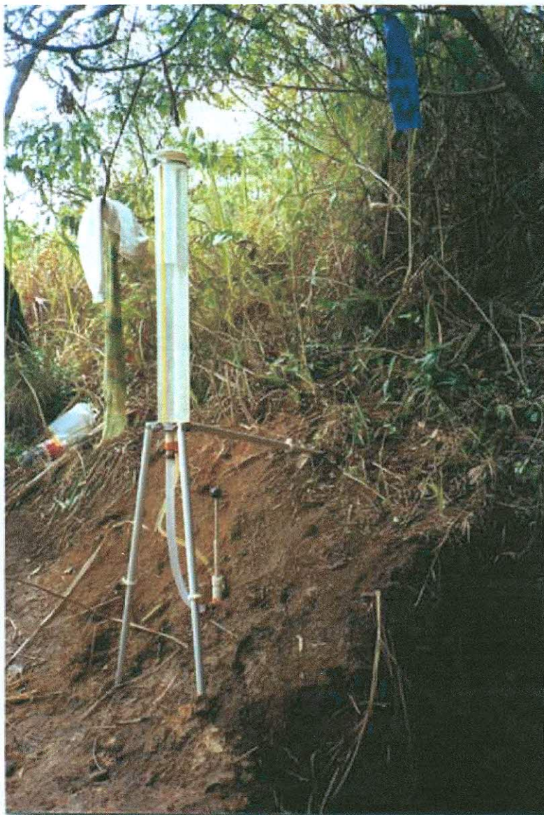
Figura 13 – PGM utilizado em uma encosta bastante íngreme. Pode-se observar que a estrutura do seu tripé é capaz de sustentar perfeitamente o equipamento, não permitindo que o seu peso seja transferido para o fundo do furo.
