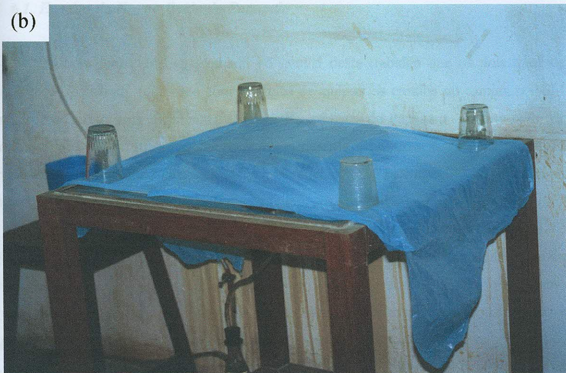
Figura 39 - Amostras indeformadas sobre a mesa de tensão onde uma carga de pressão de 60 cm de água está sendo aplicada para retirada da água dos macroporos (a) e amostras cobertas com um plástico para diminuir o efeito da evaporação (b)
