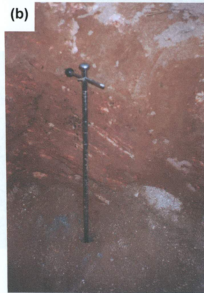
Figura 36 - Extrator de Umland utilizado na coleta de amostras indeformadas e os acessórios necessários para a coleta (martelo, espátula e cilindros) (a) e Extrator sendo utilizado no campo (b).
