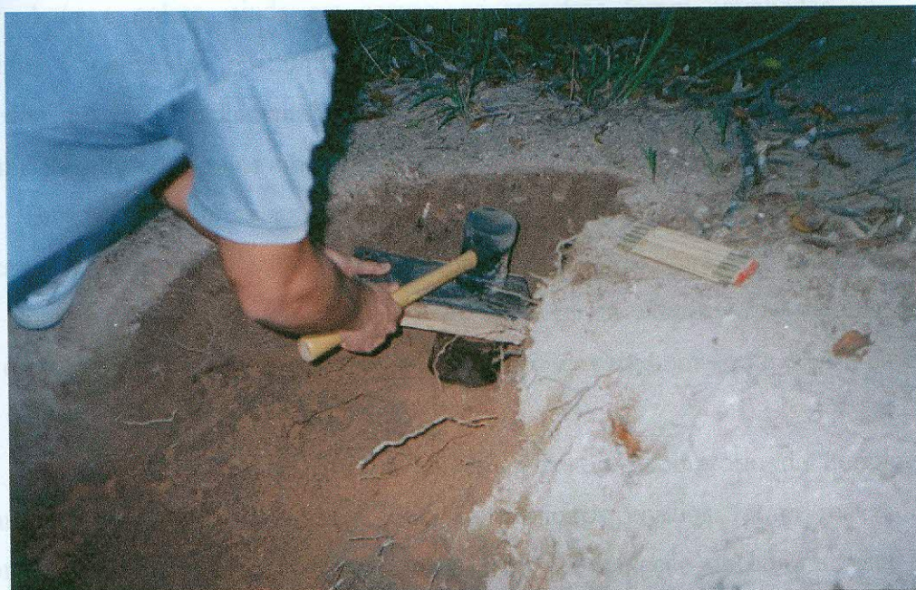
Figura 33 - Coleta de uma amostra indeformada verticalmente orientada
