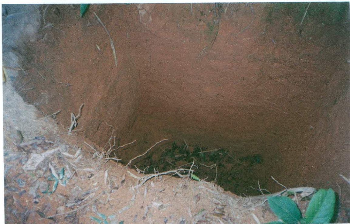
Figura 60 – Trincheira com aproximadamente 2,5m de profundidade onde foram realizados alguns ensaios da K_{sat} com o PGM. Este perfil não possui um horizonte A espesso como no perfil C3P1 e se apresenta bastante homogêneo em toda sua extensão. Não foram identificados materiais mais grosseiros, como grãos de quartzo, nas maiores profundidades.
