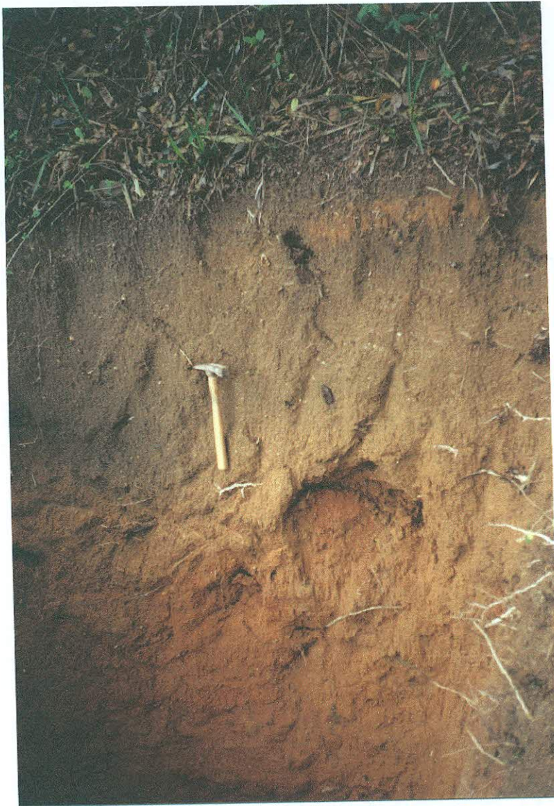
Figura 65 – Perfil do ponto C4P2 apresentando um horizonte bem desenvolvido com grande porcentagem de raízes sobrejacente a um horizonte B bastante profundo.
