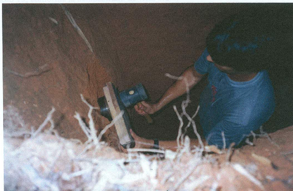
Figura 34 - Coleta de uma amostra indeformada horizontalmente orientada
