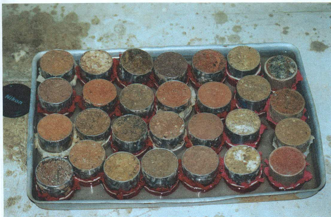
Figura 38 - Amostras indeformadas coletadas com o extrator de Uhland sob processo de saturação.
