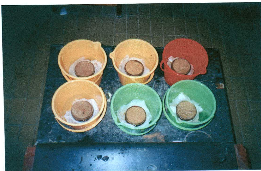
Figura 35 - Amostras indeformadas durante o processo de saturação em laboratório para posterior ensaio da K_{\text{sat}} .
