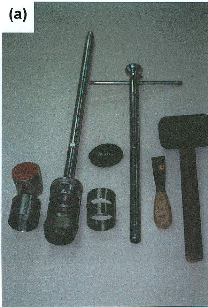
Figura 36 - Extrator de Umland utilizado na coleta de amostras indeformadas e os acessórios necessários para a coleta (martelo, espátula e cilindros) (a) e Extrator sendo utilizado no campo (b).
