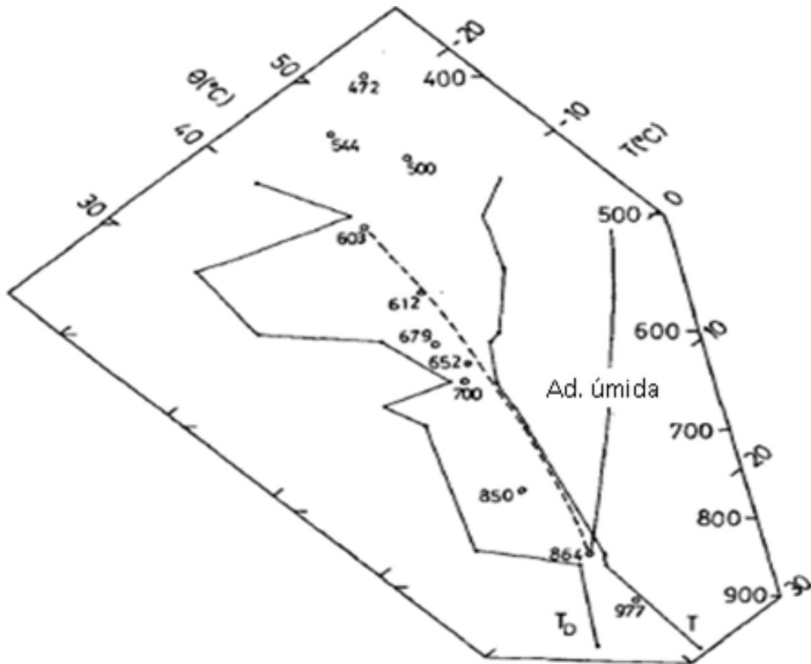
Figura 2.10 Sondagem das 18:00h (UTC) do dia 19 de julho de 1977 em Pittsburgh, plotada convencionalmente T(p) e T_d(p) como linha sólida, ponto de saturação ( T_{ns}, p_{ns} ) em ciclos abertos rotulados com dados de nível de pressão p . A linha tracejada é uma ilustração de linha de mistura entre os PS's de 603 mb à 864 mb. Fonte: original de Betts (1982).
