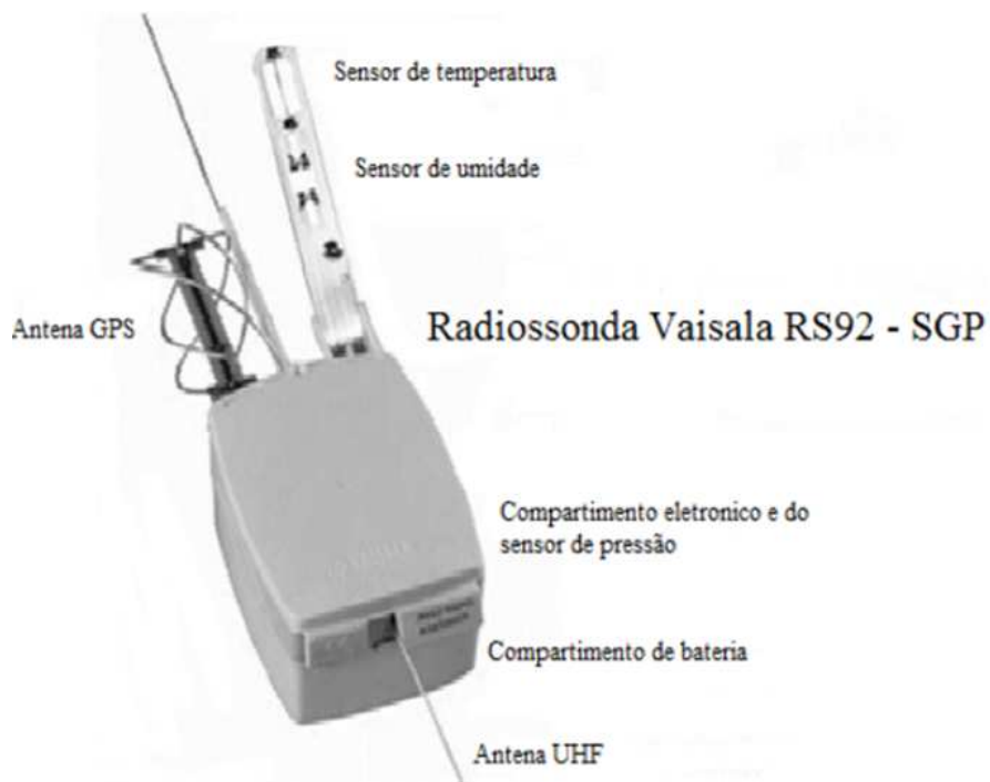
Figura 3.4 Radiossonda Vaisala, modelo RS92-SGP, lançada durante as campanhas do MCITY no RJ. Fonte: Vaisala.
