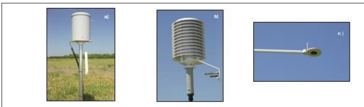
Figura 3.5 - Instrumentos de medida da precipitação (Pluviômetro) (a), da temperatura do ar e umidade relativa do ar (termohigrômetro) (b) e da radiação (radiômetro) (c).
