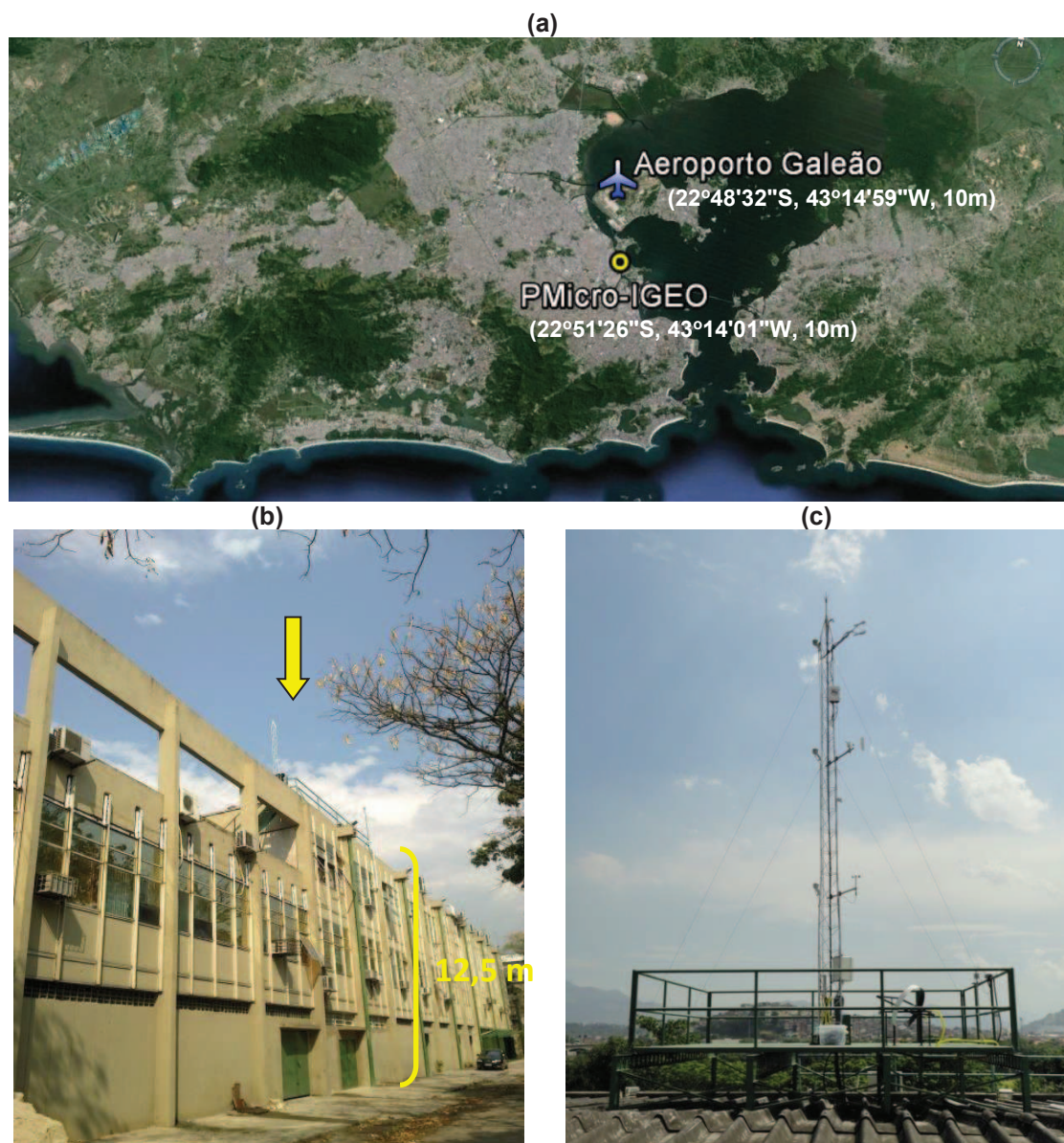
Figura 3.1 - (a) Localização geográfica da PMicro (IGEO-UFRJ) e do Aeroporto do Galeão aonde foram realizadas as campanhas de radiossondagem; (b) Prédio do IGEO (bloco H2) com 12,5 m de altura, localizado no Campus da Ilha do Fundão-UFRJ, aonde foi instalada a plataforma (seta indicativa em amarelo); (b) PMicro-IGEO de 6 m 2 com o conjunto instrumental instalado na torre micrometeorológica de 10 m. Fotos tiradas em fevereiro de 2013.
