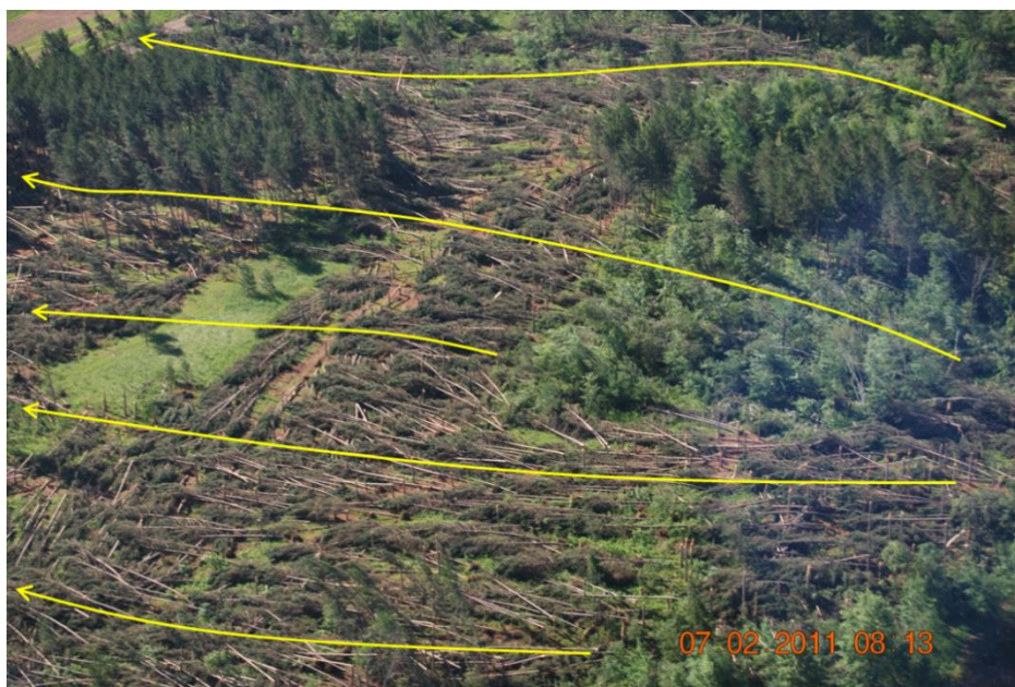
Figura 2.2: Destruição causada por uma rajada descendente. As setas mostram a direção do escoamento junto à superfície (Fonte: NOAA).
