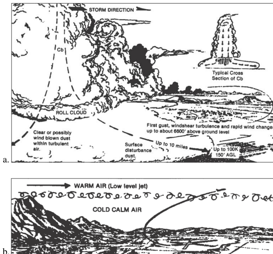
Figura 2.10. Formas de geração de cisalhamento do vento: (a) a partir de tempestades severas e (b) por inversões térmicas e pela topografia. Fonte: Beaudette, 2006.
