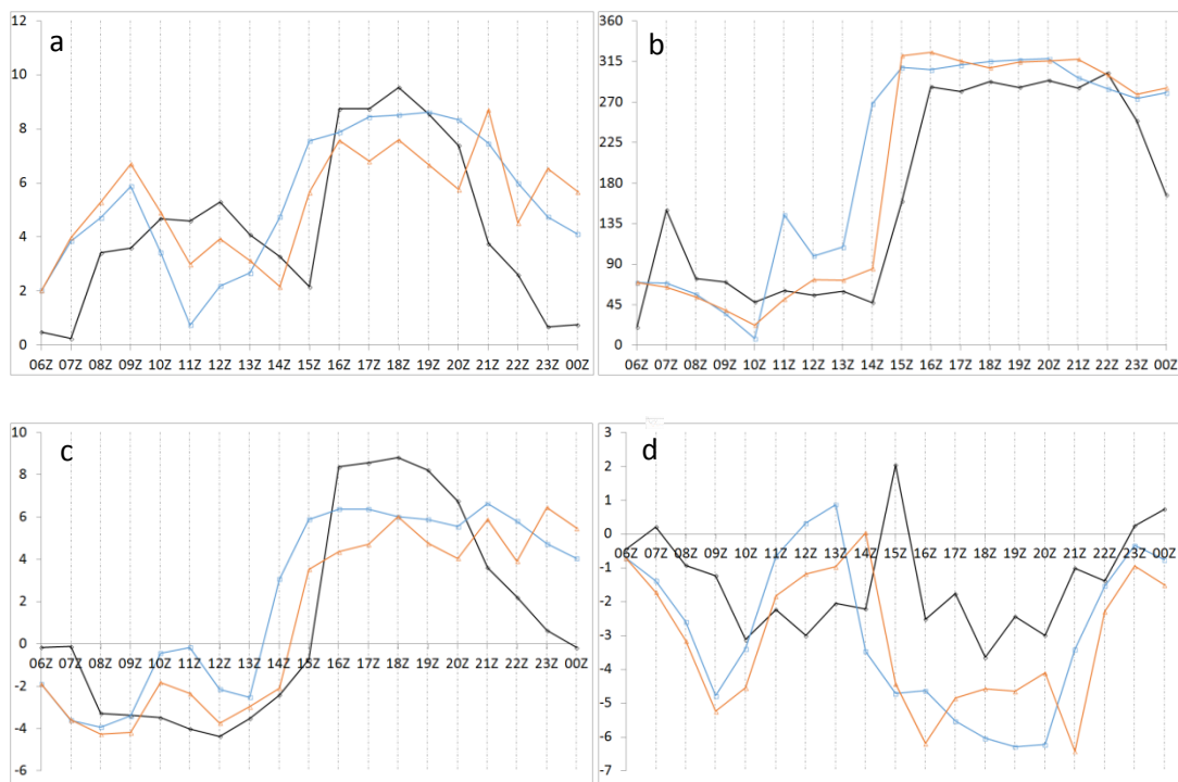
Figura 4.22. Série temporal do SODAR (preto) e dos experimentos EPGFS (azul) e ERGFS (laranja) da a) velocidade do vento (m/s), b) direção do vento ( ^{\circ} ), c) componente U (m/s) e d) V (m/s) da pista 27 para o nível \eta=2 .
