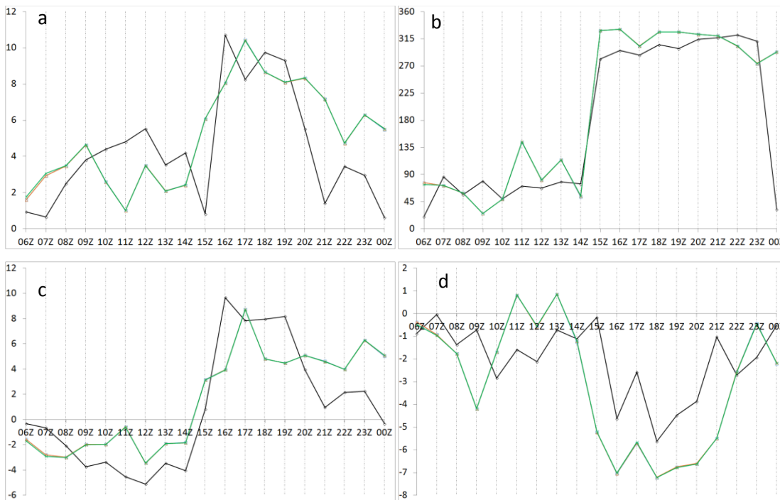
Figura 4.2. Série temporal do SODAR (preto) e dos experimentos ERGFS (verde), ERFM4 (laranja) e ERFM8 (azul) da a) velocidade do vento (m/s), b) direção do vento ( ^{\circ} ), c) componente U (m/s) e d) V (m/s) da pista 09R para o nível \eta=2 .
