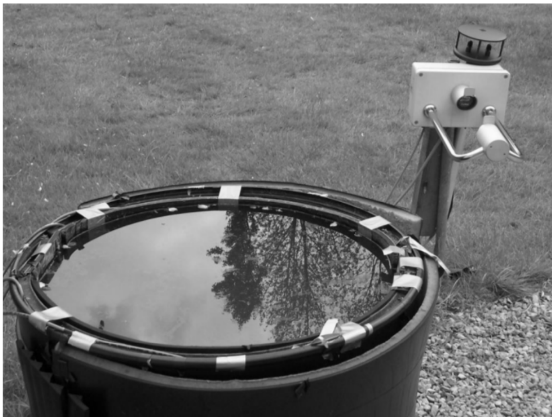
Figura 2.1: Disdrômetro acústico de reservatório de água proposto por Winder (2010)[1], em primeiro plano. Um disdrômetro óptico Thies usado na verificação de resultados também foi instalado para obter medidas simultâneas (em segundo plano, à direita).
