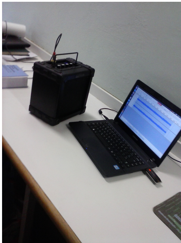
Figura 3.3: Mesa de gravação do som das gotas de chuva que impactam o sensor do disdrômetro sônico.
