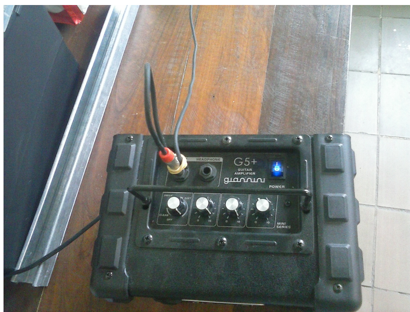
Figura 3.2: Amplificador Giannini (modelo G5+) utilizado na pré-amplificação do áudio observado na etapa anterior à gravação.
