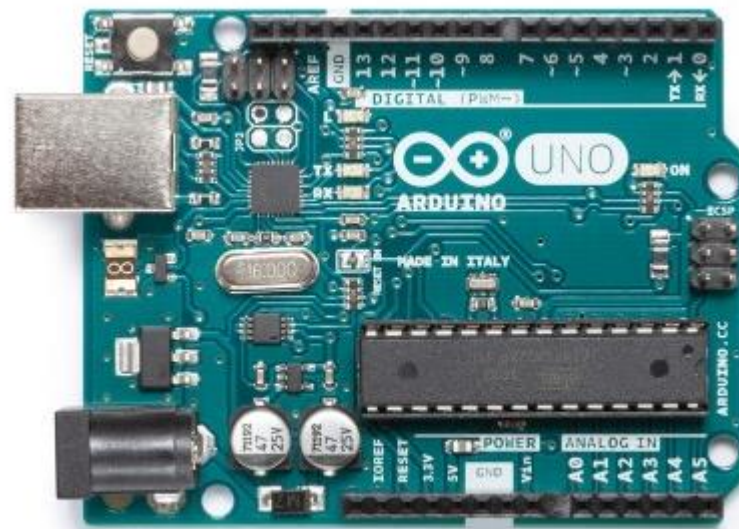
Figura 2.14: Arduino Uno REV3. Fonte: Arduino, 2018.
