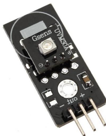
Figura 3.2: Sensor de Raios Ultravioleta UVM-30A. Fonte: Logoele, 2016.
