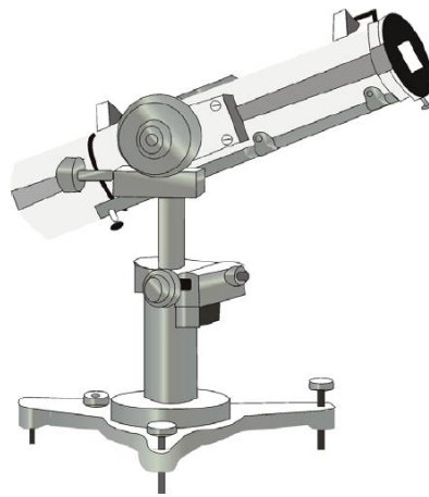
Figura 2.12: Pireliômetro de Compensação de Ångstrom. Fonte: Varejão-Silva, 2006.
