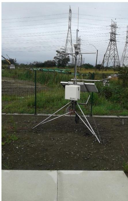
Figura 25: Estação micrometeorológica instalado nas dependências da TKCSA. Fonte: Elaborada pelo autor.
