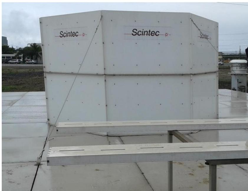
Figura 23: SODAR/RASS instalado nas dependências da TKCSA. Fonte: Elaborada pelo autor.
