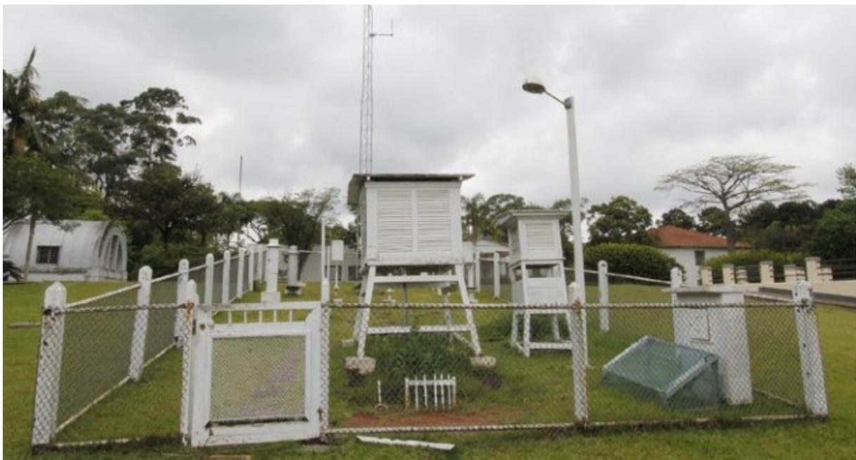
*Figura 1: Estação Meteorológica convencional do IAG no Parque CienTec. Fonte: Marcos Santos/USP Imagem.*
