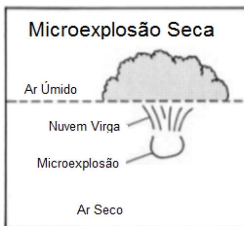
Figura 2.3. Perfil característico de uma microexplosão seca. Fonte: Adaptado de Caracena; Holle; Dowell (1989).
