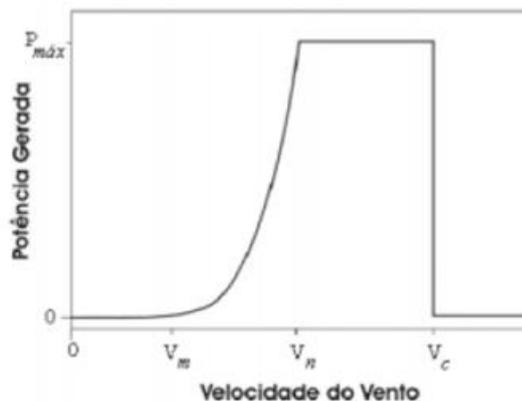
Figura 3.13: Curva de Potência de uma Turbina (Fonte: LÍVIA e PEREIRA (2018)).
