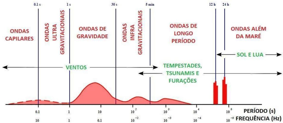
Figura 2.9: Distribuição de frequência das ondas no oceano por classificação (informações em vermelho) e força geradora (informações em verde). Fonte: Adaptada de Munk (1950).
