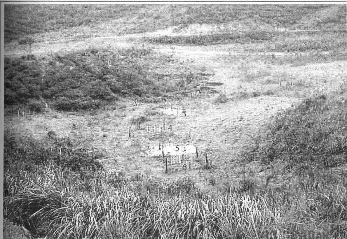
Figura 37 Foto das estações de monitoramento da água subterrânea localizadas no perfil situado a montante do dígito ativo da porção superior.
