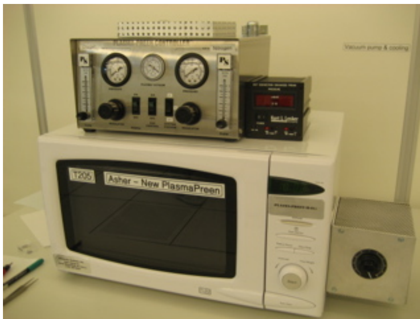
Figura 3.16: Equipamento para remoção de resíduos de PMMA por plasma de oxigênio.
