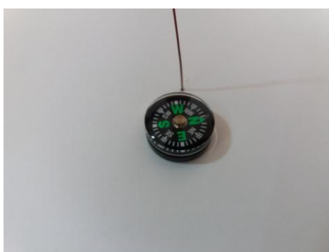
Figura A.5. Bússola nas vizinhanças do fio condutor sem corrente elétrica.
