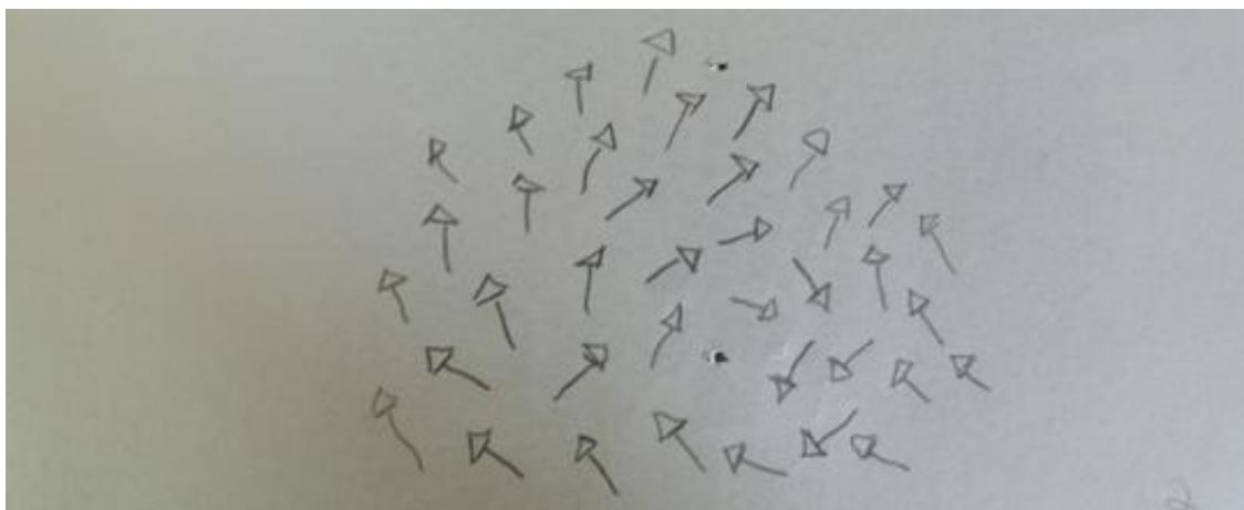
Figura 4.5. Desenho das linhas de campo magnético nas vizinhanças de um fio.
