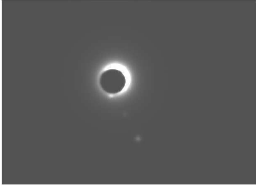
Figura 3.3: Imagem apresentando um máscara de coronografia como um anteparo físico à luz da fonte brilhante (Assafin et al. 2008).
