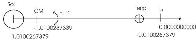
Figura 4.25: Coordenadas adimensionais para o sistema Sol-Terra
