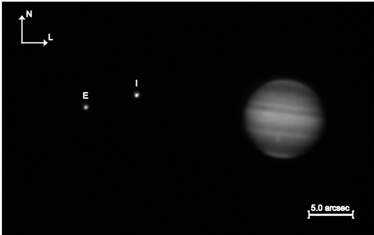
Figura 1.2: Imagem de Júpiter, Io e Europa, indicado por suas iniciais, obtida pelo telescópio ZEISS de 0,6 metros de diâmetro, equipado com a câmera CCD Ikon-L e o filtro Metano de banda estreita. Devido o filtro centrado em  $\lambda = 889 \text{ nm}$  com largura de  $15 \text{ nm}$  a luz difusa de Júpiter é minimizada. O planeta e os satélites apresentam o mesmo brilho aparente.
