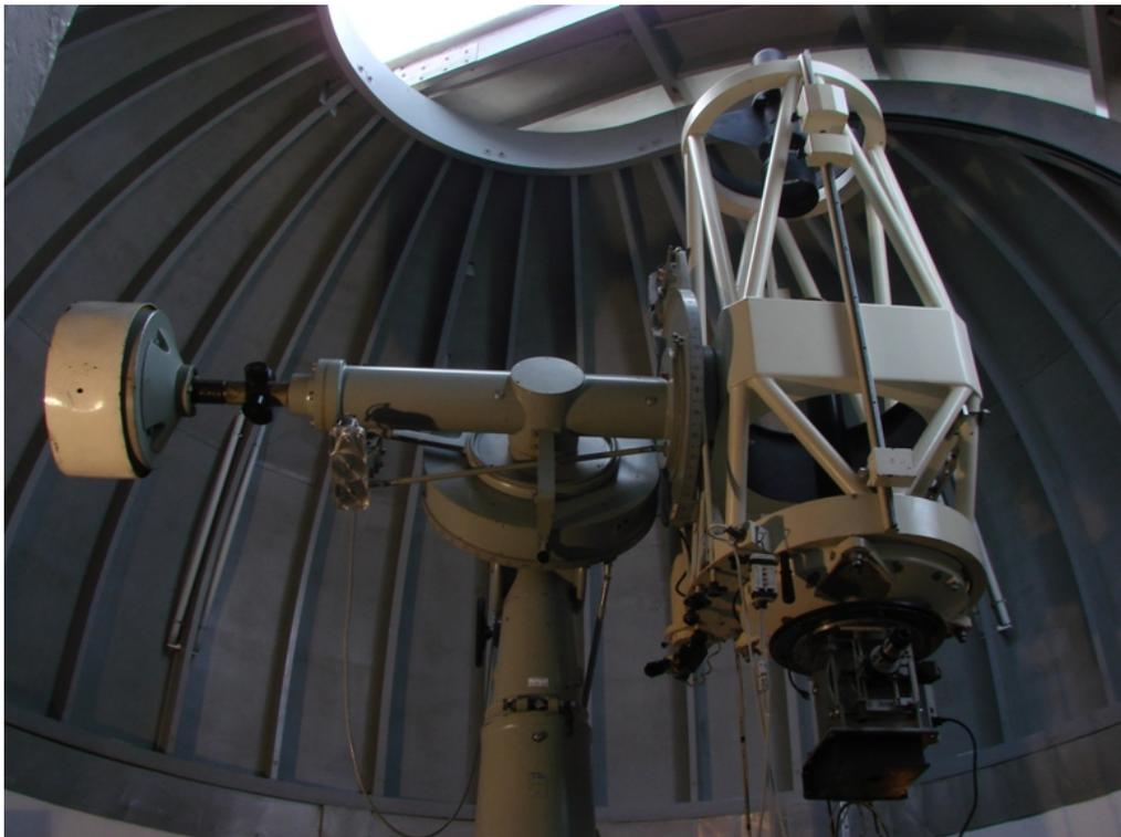
Figura 3.6: Telescópio ZEISS de 0,60 metros de abertura do OPD/LNA.
