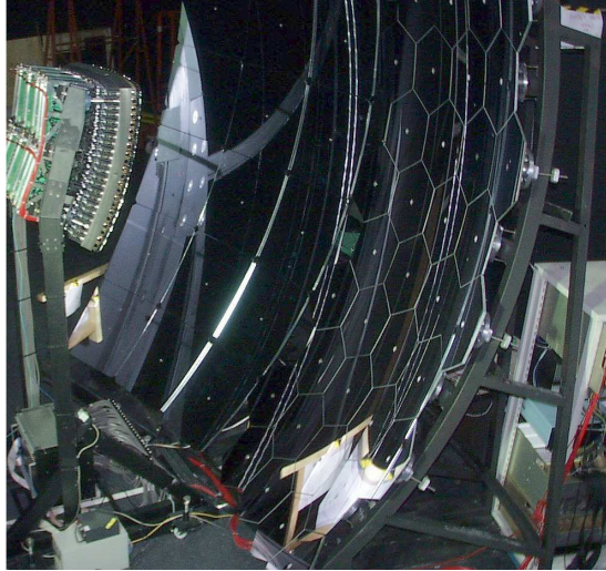
Figura 2.8: Protótipo de um telescópio de fluorescência [65].
