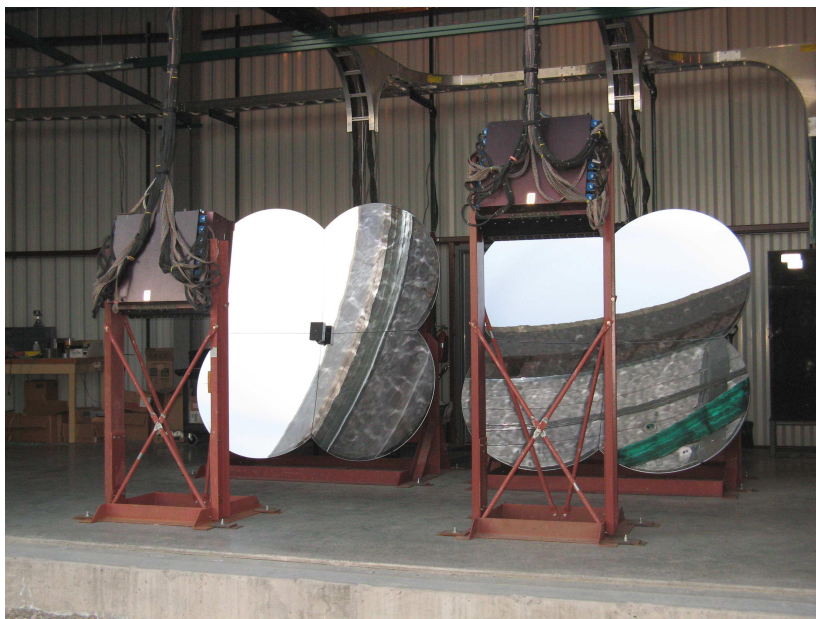
Figura 3.6: Na foto um par de espelho de MD, o telescópio da direita aponta de 3^\circ - 17^\circ acima do horizonte, enquanto da esquerda de 17^\circ - 31^\circ acima do horizonte [76].
