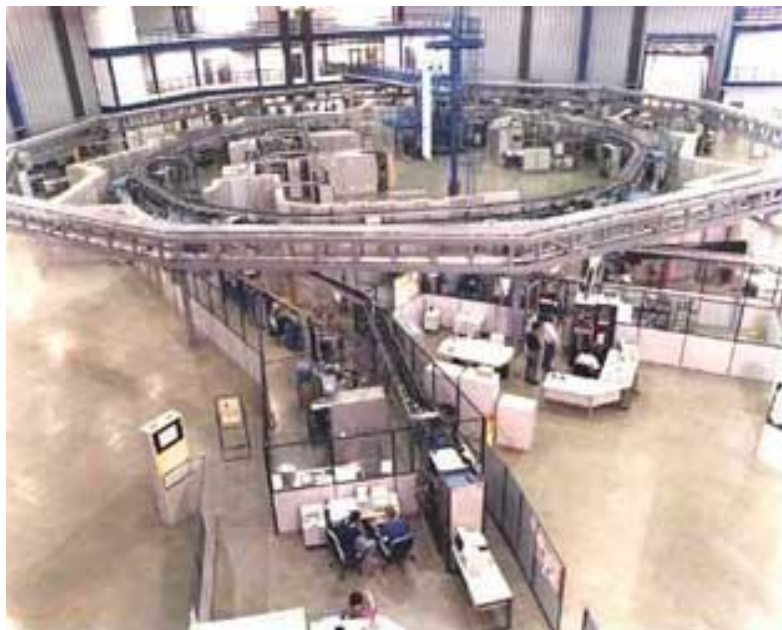
Figura 4.5 – Anel de armazenamento, LNLS
