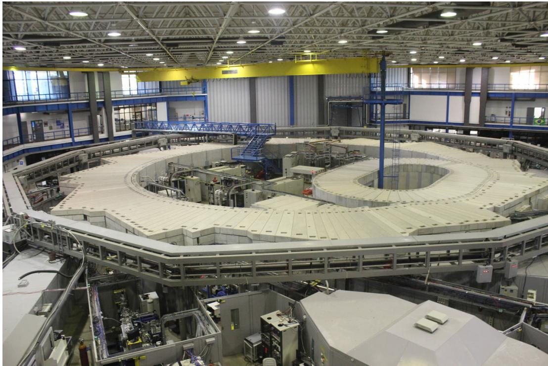
FIGURA 3.4: Foto do acelerador síncrotron UVX, primeira fonte de luz síncrotron do Brasil.
