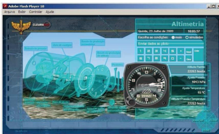
**Figura 6.4 A estrutura interna do Altímetro**
