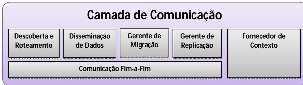
Figura 4.5: Diagrama de blocos da camada de comunicação
