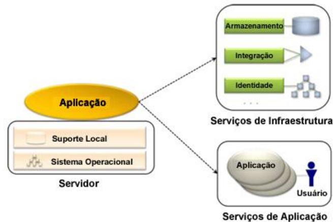
**Figura 2.6: Modelo de plataforma de aplicação (CHAPPEL 2009)**
