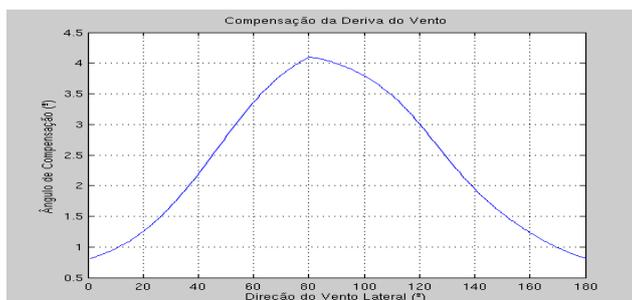
Figura 5.3– Dependência da velocidade e direção em função da direção coplanar do vento
