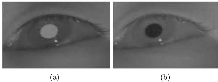
Figura 2.5: Exemplo de captura com iluminação (a) próxima à câmera e (b) distante da câmera (HANSEN E JI, 2010)
