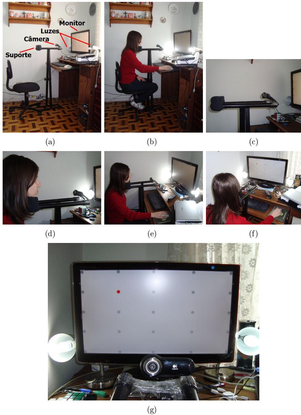
Figura 4.1: Ambiente de captura: (a) visão geral, (b) usuário no ambiente, (c-d) detalhe do suporte, (e-f) outros ângulos de visão e (g) ponto de vista do usuário
