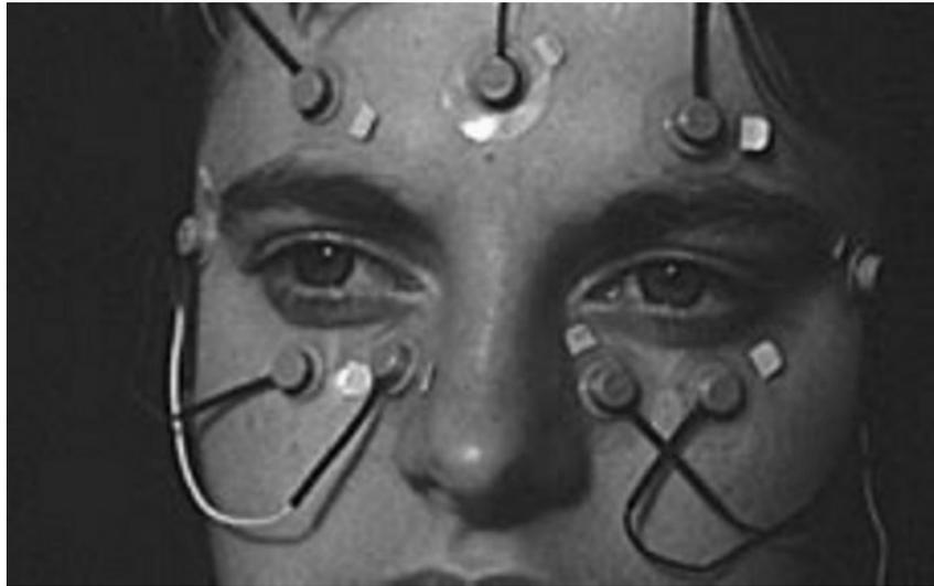
Figura 2.1: Exemplo de sistema de eletro-oculografia (DUCHOWSKI, 2007)
