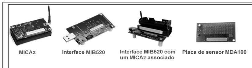
Figura 19. Dispositivos para a plataforma *MICAz*
