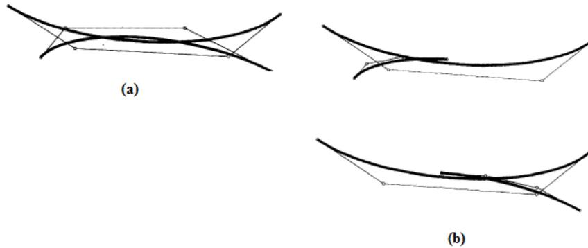
Figura 3.12: (a) Duas interseções; (b) Resultado após a subdivisão de uma das curvas
