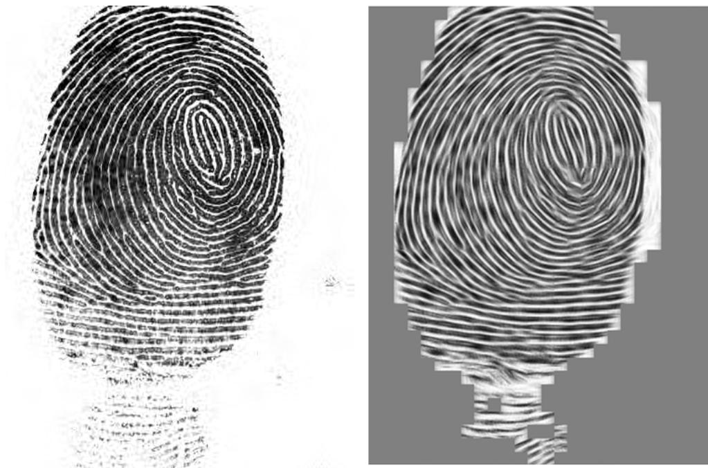
Figura 5.22: Aplicação do filtro de Gabor sobre a imagem de impressão digital.
