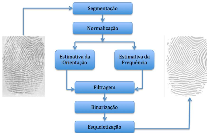
Figura 4.1: Algoritmo da etapa de pré-processamento.
