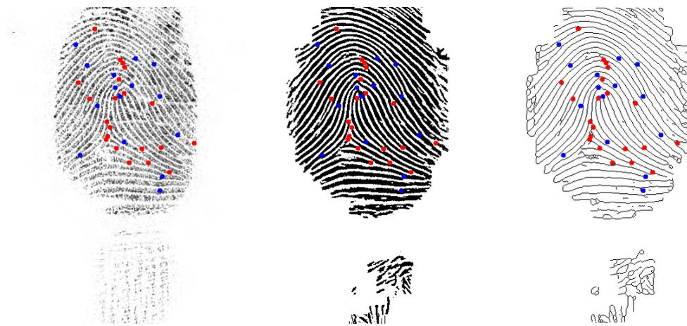
Figura 5.43: Pontos característicos detectados. Em azul estão as terminação e em vermelho as bifurcações. À esquerda estão em destaques as minúcias sobre a imagem original, ao centro os pontos característicos sobrepostos à imagem binarizada e à direita sobre a imagem esqueletizada
