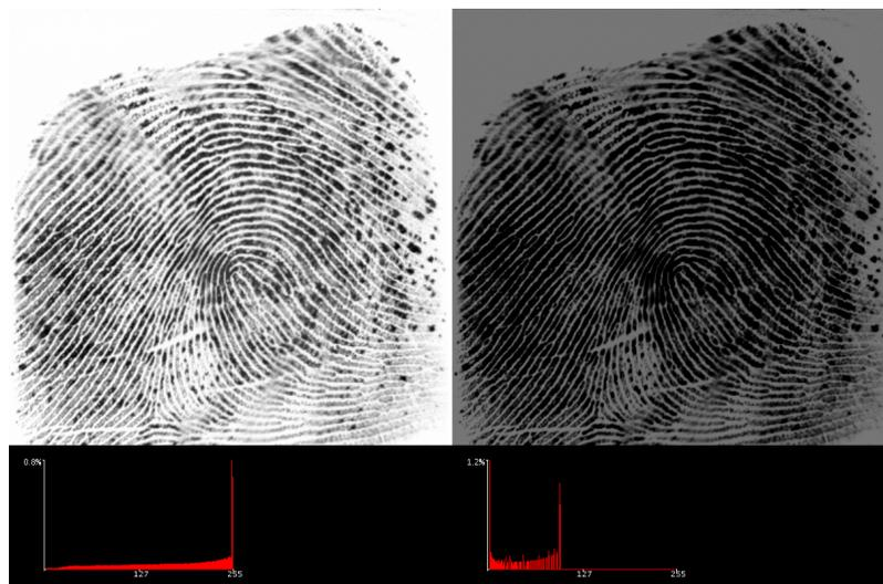
Figura 5.9: Exemplo de imagens de impressão digital normalizada (à esquerda imagem original, à direita imagem segmentada e abaixo seus respectivos histogramas).
