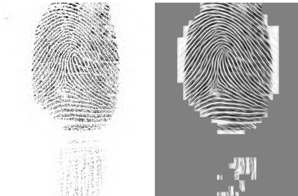
Figura 5.21: Aplicação do filtro de Gabor sobre a imagem de impressão digital.
