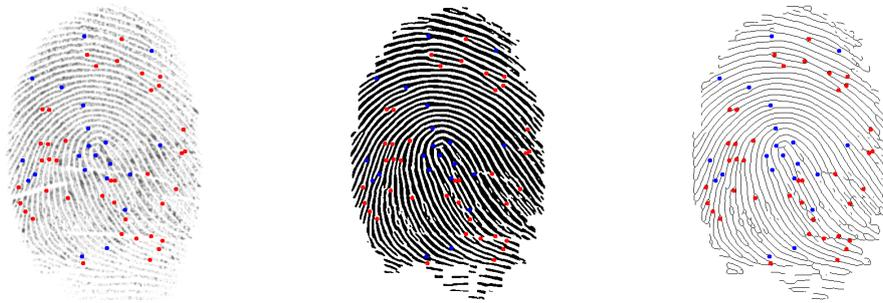
Figura 5.41: Pontos característicos detectados. Em azul estão as terminação e em vermelho as bifurcações. À esquerda estão em destaques as minúcias sobre a imagem original, ao centro os pontos característicos sobrepostos à imagem binarizada e à direita sobre a imagem esqueletizada
