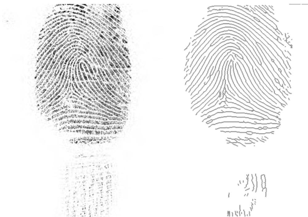
Figura 5.31: Exemplo de esqueletização da imagem de impressão digital binarizada.
