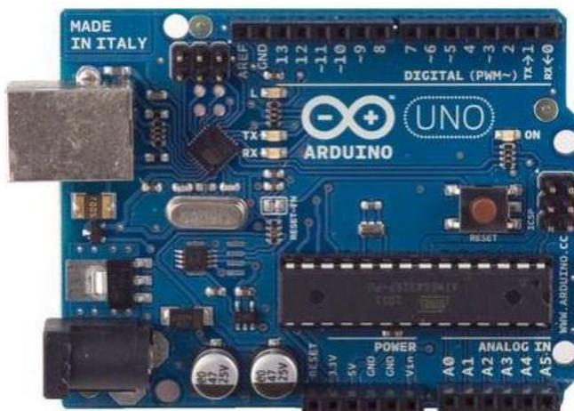
Figura 2.1: Placa Arduino modelo UNO R3, usada neste trabalho
