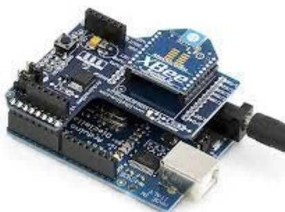
Figura 5.2: Arduino UNO com a placa *XBee Shield*
