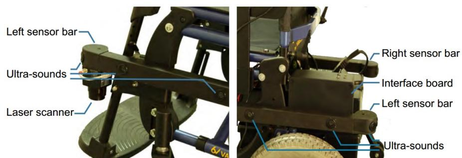
Figura 2.16: Detalhes das partes frontal (esq.) e traseira (dir.) da barra esquerda de sensores [43].
