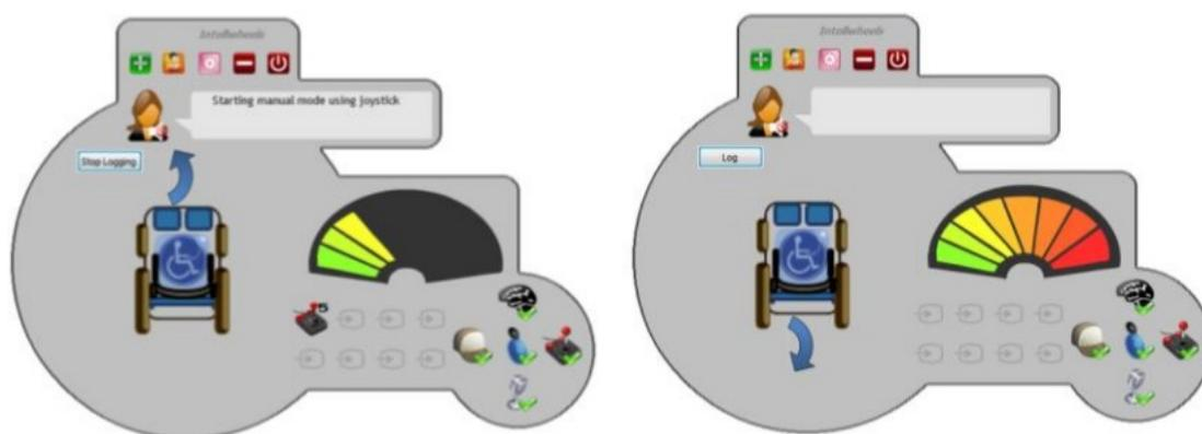
Figura 2.13: Interface gráfica da IWP, com destaque para as indicações de direção e velocidade da CRI [22].
