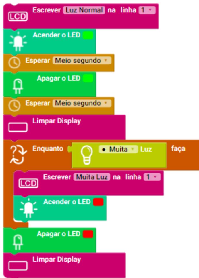
Figura 52: Programa a ser construído na segunda atividade
