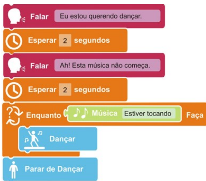
Figura 44: Programa para o robô humano utilizando o bloco enquanto
