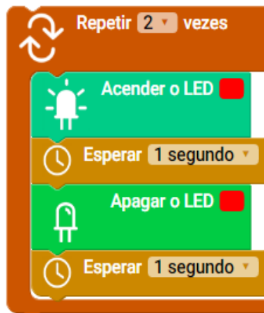
Figura 40: Sequência de blocos para fazer o LED vermelho piscar 2 vezes com o uso do bloco repetir .
