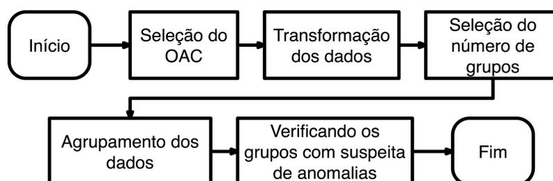
Figura 4.2: Fluxograma para o procedimento de análise dos resultados de um organismo de avaliação da conformidade
