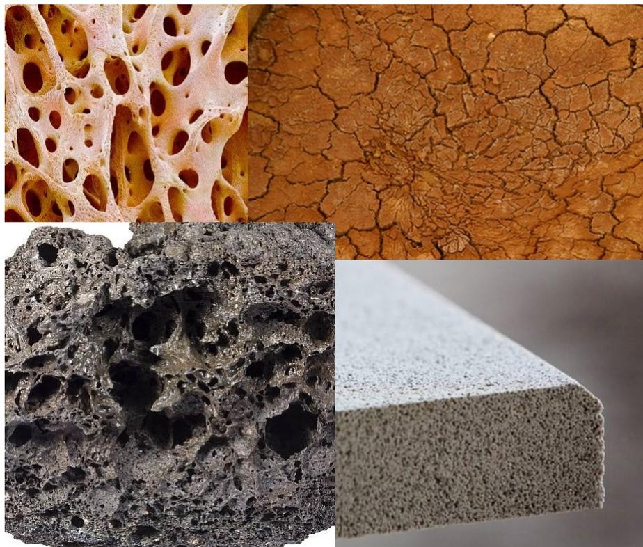
Figura 5.1: No sentido horário, imagem aproximada de uma formação óssea, solo argiloso seco compactado, vidro reciclado sinterizado, utilizado com o objetivo de isolamento acústico, rocha magmática.
