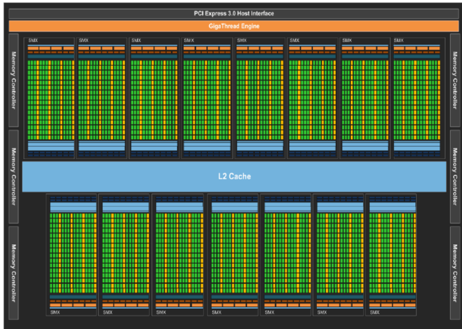
Figura 2.4: Arquitetura NVIDIA Kepler (NVIDIA, 2014)
