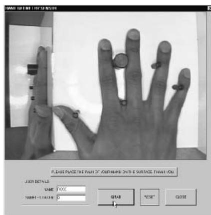
**Figura 2.11 – Aparelho de captura da imagem da mão. Os pinos indicam como a pessoa deve usar o aparelho. O Espelho, à esquerda da imagem, permite que a câmera capture a imagem da lateral da mão.**
