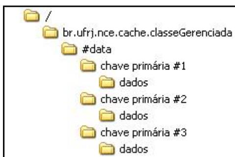
**Figura 5.1 – Estrutura utilizada para armazenamento dos dados dos componentes de persistência em cache**
