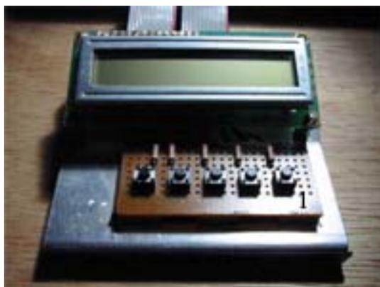
Figura 18 – Display e Teclado. (1) Botão que comanda o início da execução
