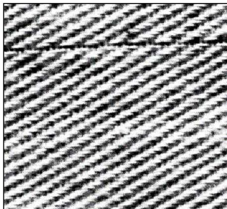
**Figura 3.19:** Tecido com defeito em forma de linha horizontal na parte superior da imagem
