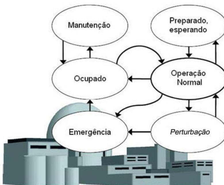
**Figura 4** – Máquina de estados de uma indústria de produção de energia
