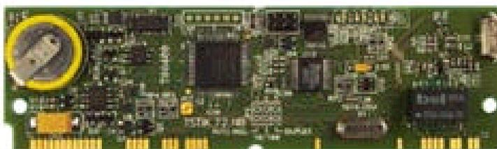
**Figura 7 – Placa TStik da Sistronix – Execução de código Java compilado para a plataforma.**
