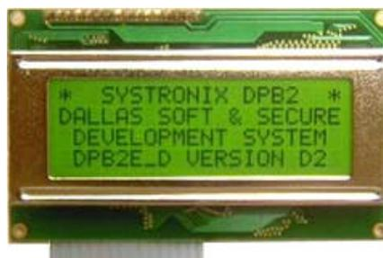
**Figura 16 – *Display* 20x4 (conectado a placa STEP via extensão SBX2).**
