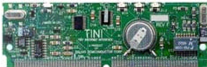
**Figura 8 – Placa TINI da *Dallas Semiconductors* (Microcontrolador DS80C390).**
