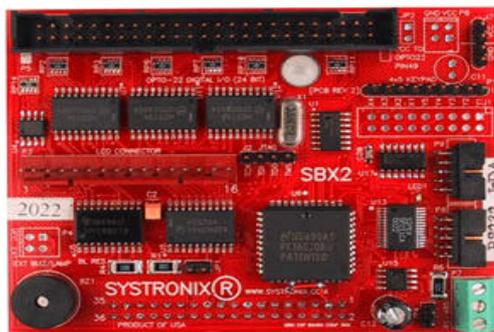
**Figura 15 – Placa de extensão SBX2 para conexão com periféricos (Ex: teclado e *display*).**
