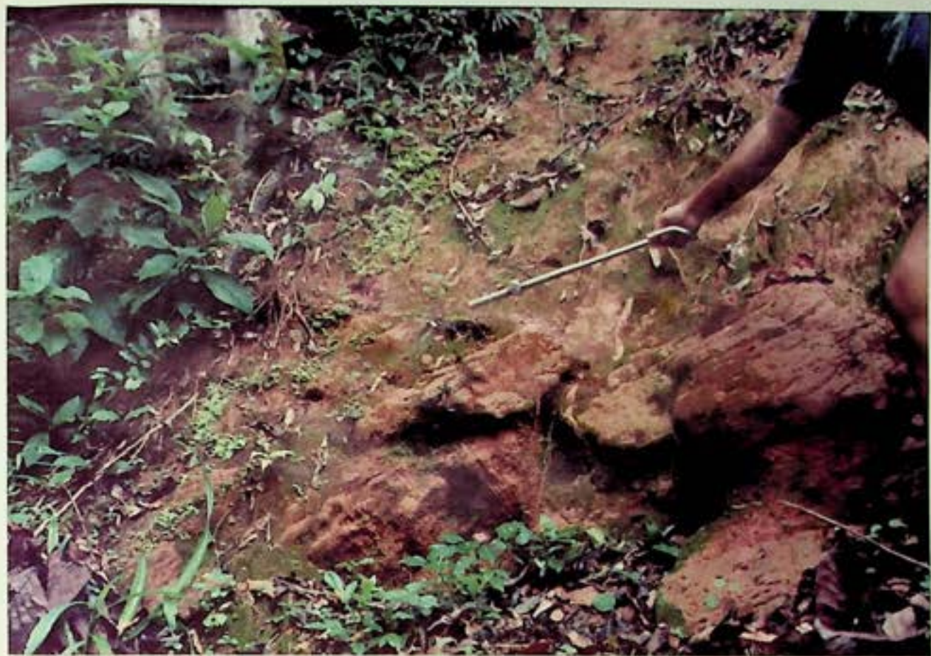
Foto 10 - Antigo escorregamento evidenciando estrutura alterada da rocha de origem.
