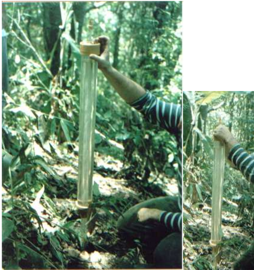
Figura 12: Permeâmetro de Gelf utilizado para mensuração da condutividade hidráulica saturada em campo.
