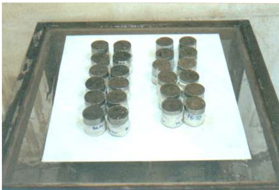
Figura 11: Mesa de tensão utilizada para determinação de macro e microporosidade.
