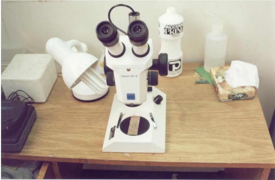
Figura 13. Identificação dos minerais na lupa (Stemi SV 6 – Zeiss, Germany). Foto de Xavier, R. A. (2001).
