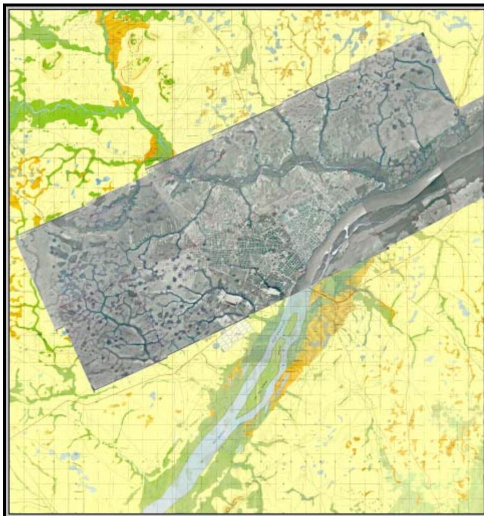
Figura 58 - Retificação de mosaico de fotografias aéreas para a extração de planos de informação.
