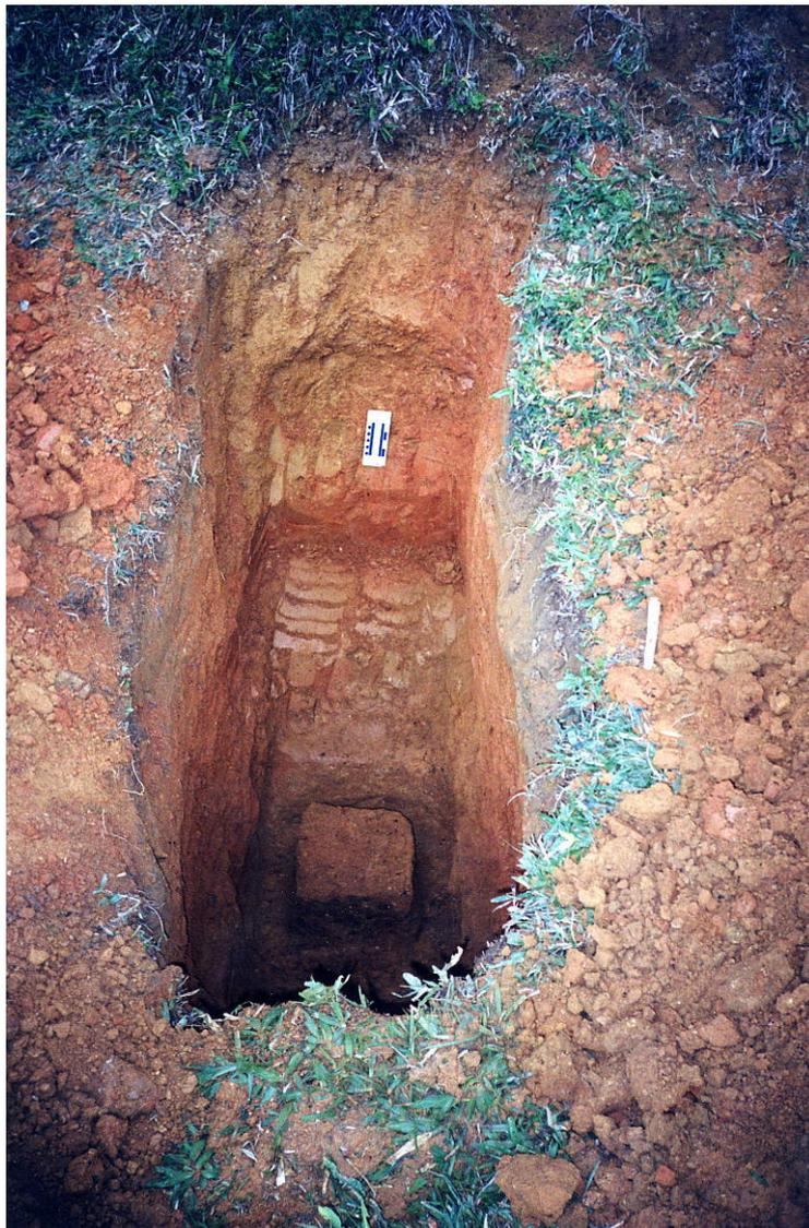
**Foto 5.1** – Trincheira de onde foram retiradas amostras para os ensaios de caracterização e comportamento geomecânico (Foto: Marga E. Pontelli, set./2001)
