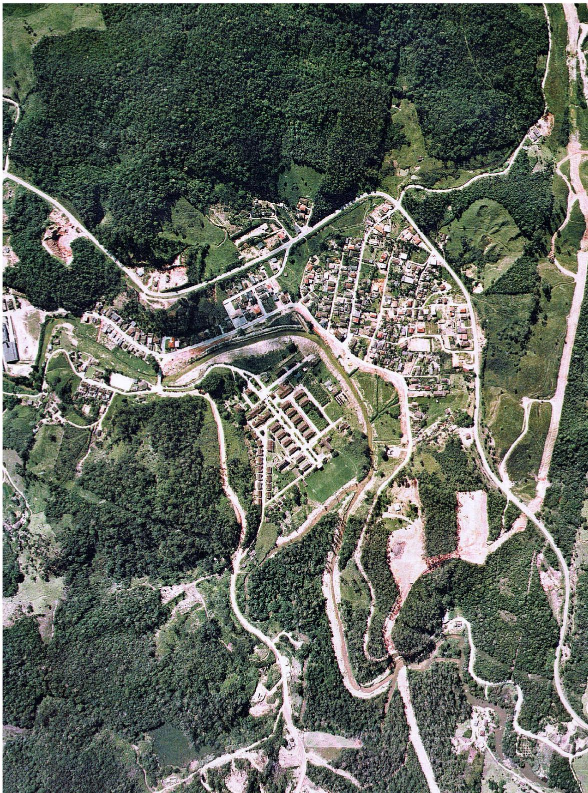
Foto 4.7 - Foto aérea colorida da localidade de Santa Teresa. Escala aproximada 1: 7.500. Observar os cortes e aterros na área. Acima da área urbanizada, é visualizada uma cabeceira de drenagem com feições erosivas. Fonte: Aeroconsult – Aerolevantamentos e Consultoria S/A, 1999.
