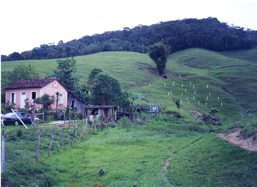
Foto 6.1 – localização dos tensiômetros na encosta. Cada estaca branca representa um ponto com um ou dois tensiômetros (Foto Heloisa P. Pôssas, out./2000).
