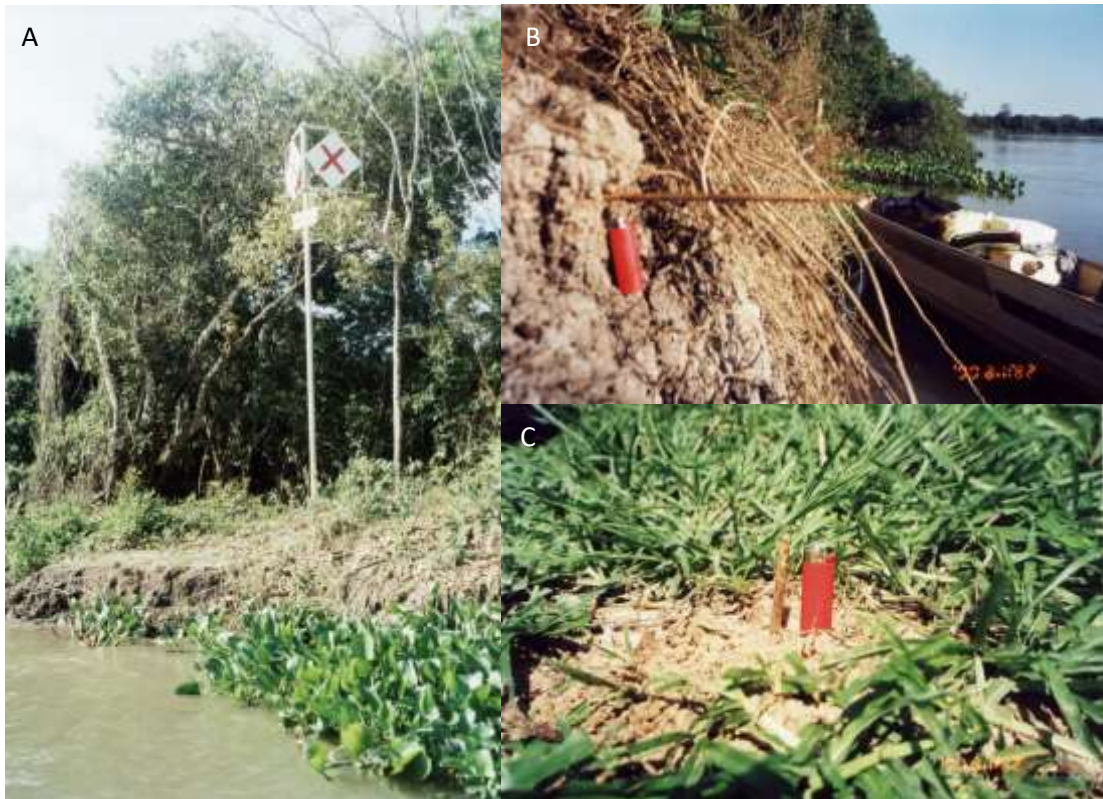
Figura 3 – Visualização dos procedimentos realizados para monitorar a erosão nas margens (A), mastro da Marinha (B), estaca e (C) pino de erosão.
