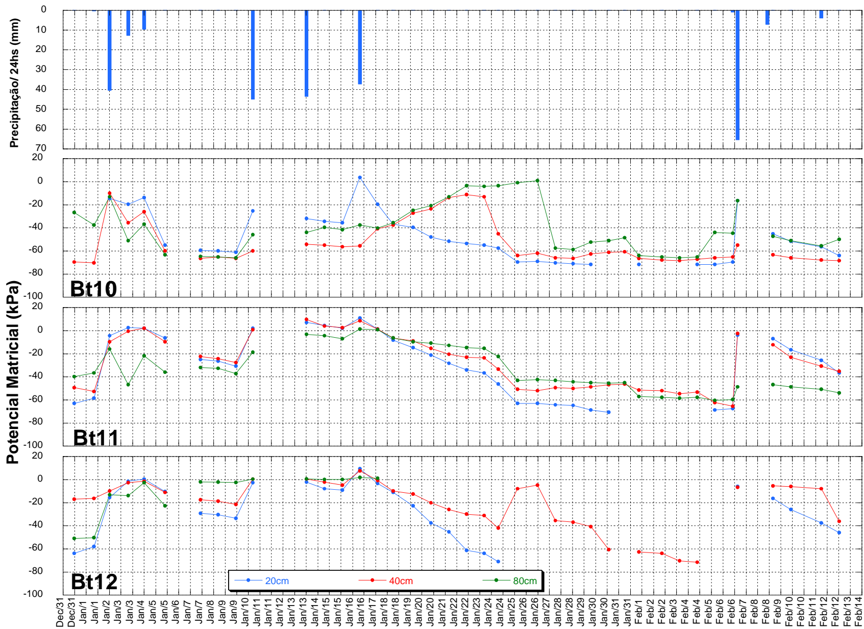
Figura 6.48. Variação dos potenciais matriciais (kPa) e eventos pluviométricos (mm/24hs) ao longo do período 2, nas estações Bt10, Bt11 e Bt12, para as profundidades de 20 cm, 40 cm e 80 cm.
