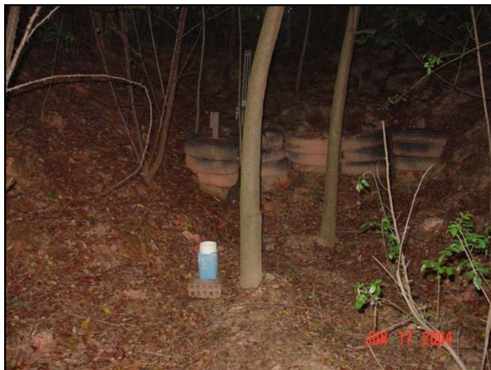
Figura 4.15. Barreira de pneus na estação Bt5. Ao fundo a bateria de tensiômetros, na frente um pluviômetro de solo nivelado utilizando-se como base um tijolo (P5).
