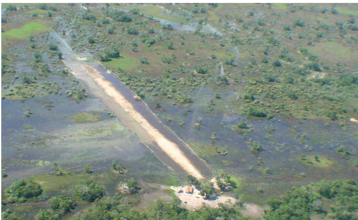
Fig. 6.4- Aterro construído sobre parte da vazante do Chico Preto no Pantanal de Cáceres, no período de cheias transforma-se em dique. Foto: A. REIS, (2004).
